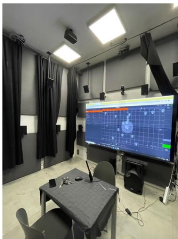
Fig. 6 カンパニア大学の実環境シミュレータ。音場, 照明, 温湿度を制御できる。
