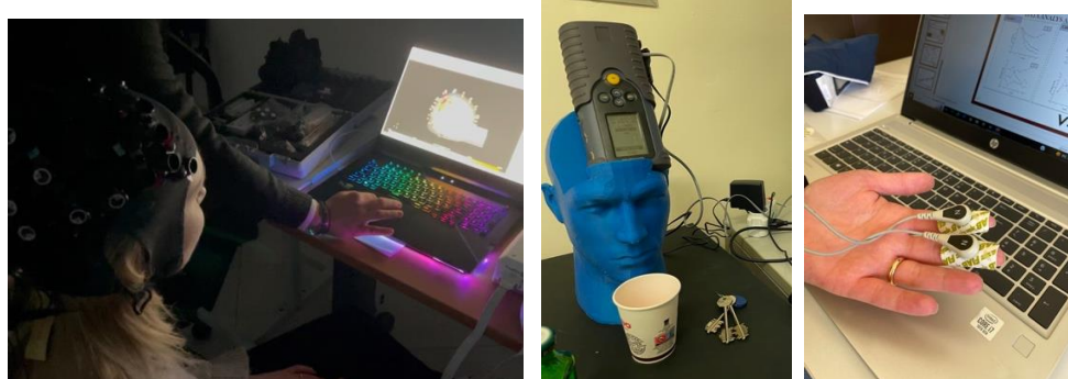
Fig. 7 カンパニア大学の実験設備の一部(左から NIRS, Odor simulator, EDA 測定装置)
