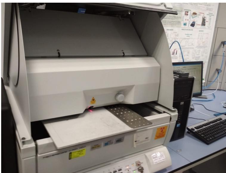
組成比評価のために使った XRF 装置
